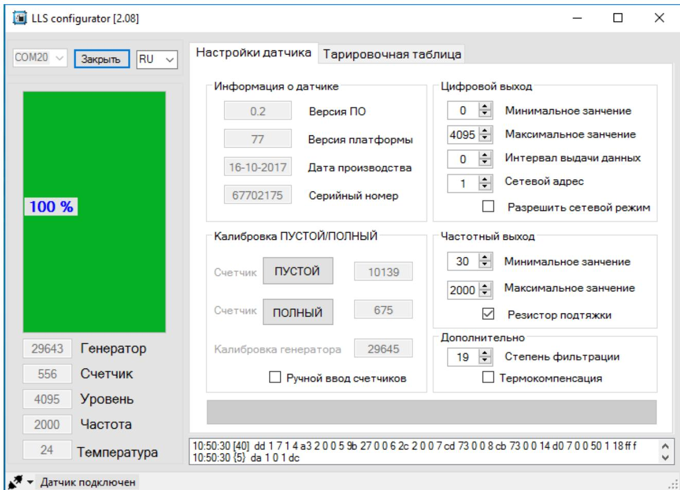
При первом запуске программа автоматически считывает настройки датчика уровня топлива и выводит их в соответствующих разделах. Далее пользователь может изменять настройки датчика согласно требованиям установки.
