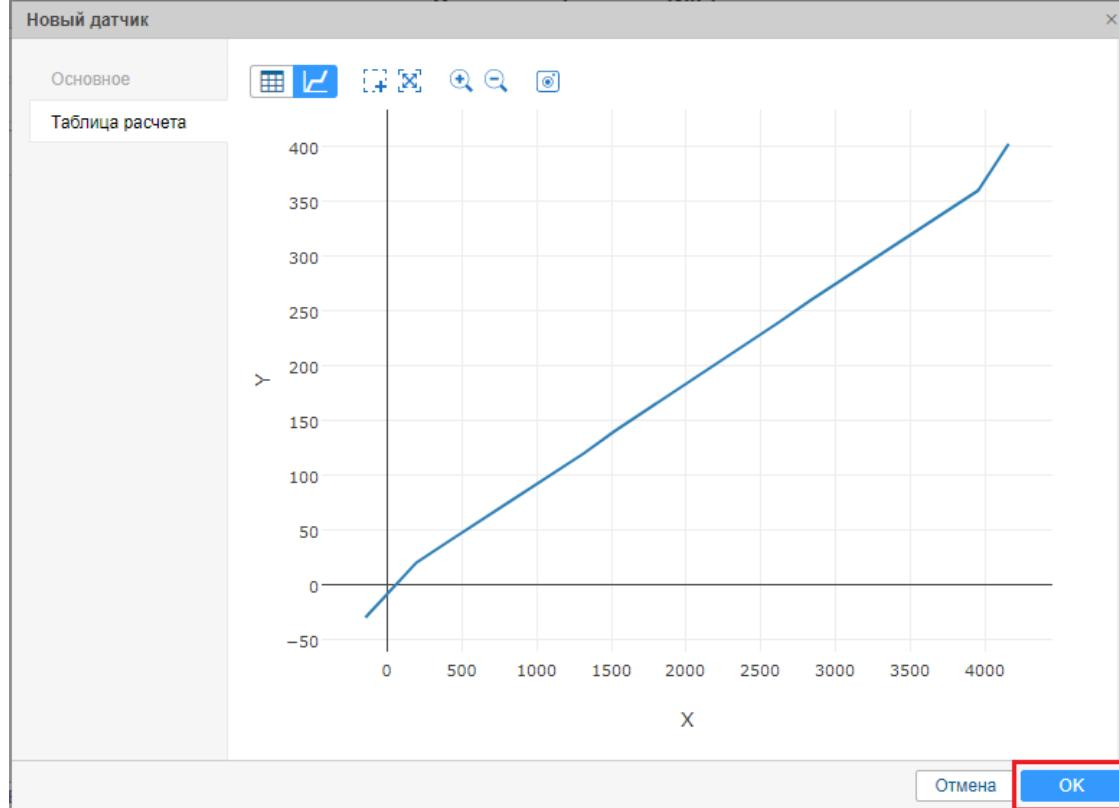
Нажимаем «OK», получаем созданный датчик уровня топлива с загруженными данными из сохранённой таблицы.
