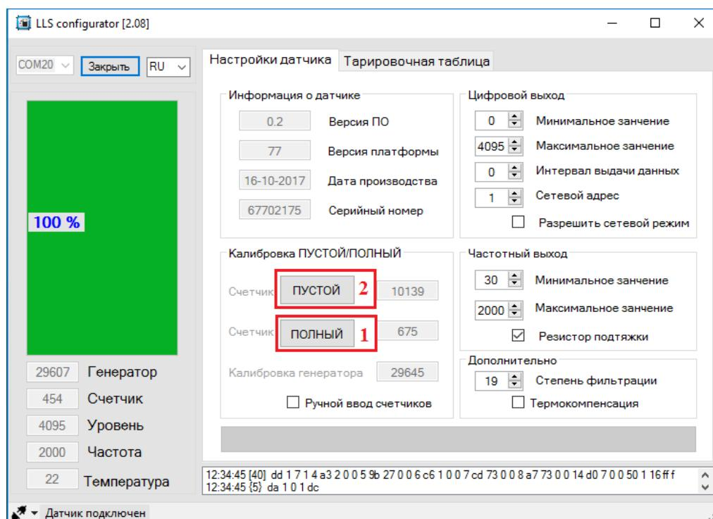
1. Опустите датчик уровня топлива в мерную емкость. Залейте в мерную емкость топливо таким образом, чтобы датчик уровня топлива был погружен на всю длину измерительной части. Выждать не менее 1 минуты, далее нажмите кнопку «ПОЛНЫЙ».
